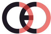
Falsche CE-Kennzeichnung (zu dicht)
