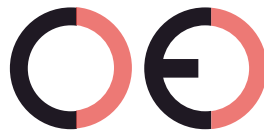
Falsche CE-Kennzeichnung (zu großer Zwischenraum)
